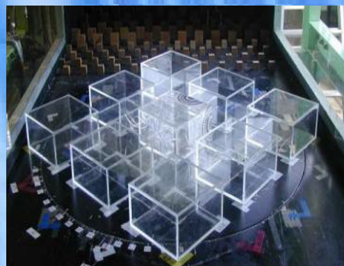
建物内の通風換気実験
