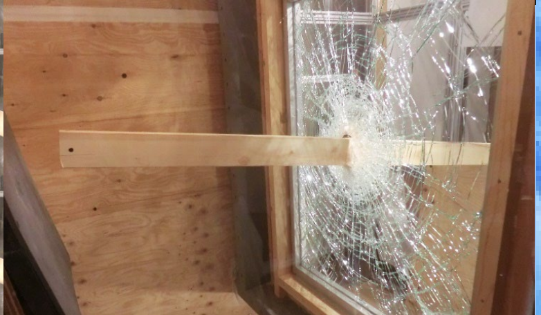
2×4の角材を高速度(30-60m/s)で射出する実験例 樹脂をラミネートして強化された合わせガラスでは、飛来物に対する耐衝撃性を示した。(写真左)
