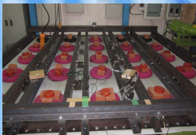
機械固定的工法防水システムの耐風圧性能試験
