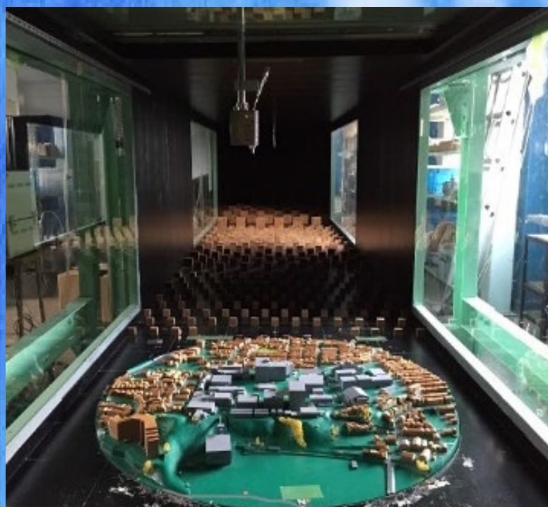
ガス拡散の風洞実験
