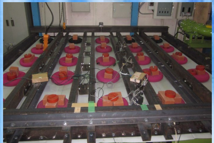
機械固定的工法防水システムの耐風圧性能試験
