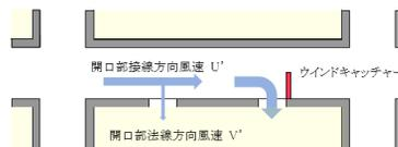
図1 ウィンドキャッチャー模式図
